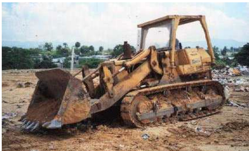
Le bulldozer est l'équipement utilisé pour répandre et compacter les résidus.
