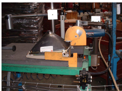
Fig.5.4 : enlèvement de la bande anti-implosion du CTR
