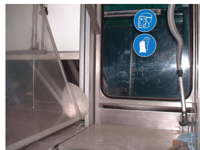
Fig. 5.5 : hotte et tube aspirateur pour le traitement de CTRs chez Triade Électronique
