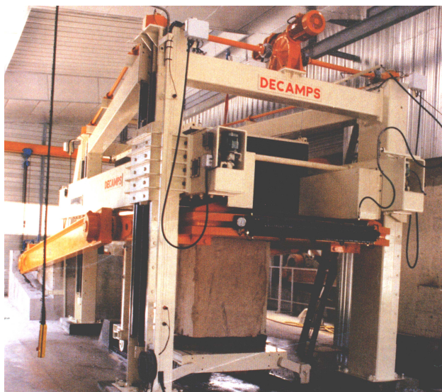
Figure 5-7. Les colonnes hébergent des vis sans fin graissées, exposées aux intempéries
