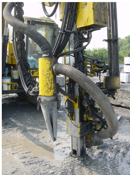
Figure 5-1. Capteur de poussière installé sur une foreuse
