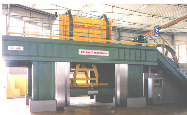
Figure 5-8. Colonne protégée pour éviter les pertes incontrôlées de huile et de graisse
