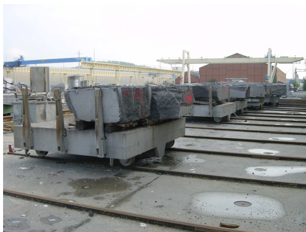
Figure 4-6. Blocs sur chars prêts à entrer dans l'usine de sciage
