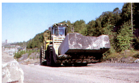
Figure 4-3. Chargeuse pour monter les blocs de Pierre Bleue
