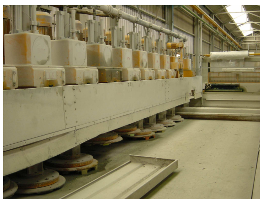
Figure 4-10. Trains polissoirs pour traiter la surface des tranches brutes
