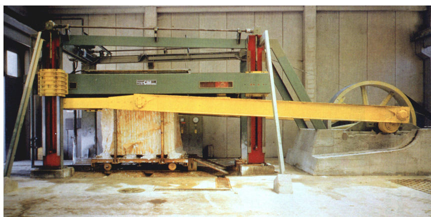
Figure 4-8. Les bielles transmettent le mouvement rotatif du volant-excentrique dans un mouvement de va-et-vient
