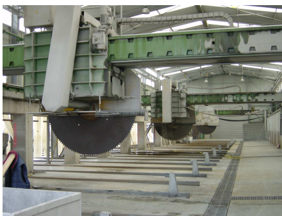
Figure 4-9. Grands disques pour le sciage des blocains
