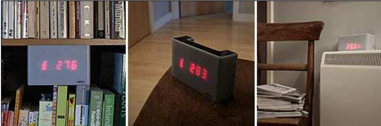
Figure 32 : Système "Wattson" d'affichage déporté de la consommation électrique instantanée<sup>159</sup>
