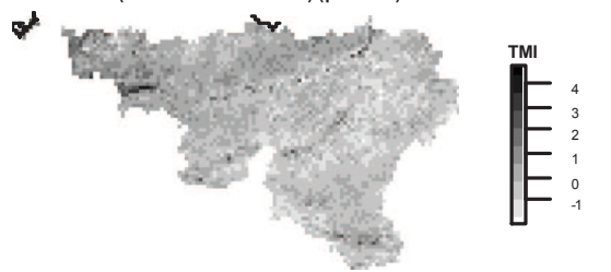
Indice topographique d'humidité TMI = (flux d'accumulation + 1) / (pente + 1)
