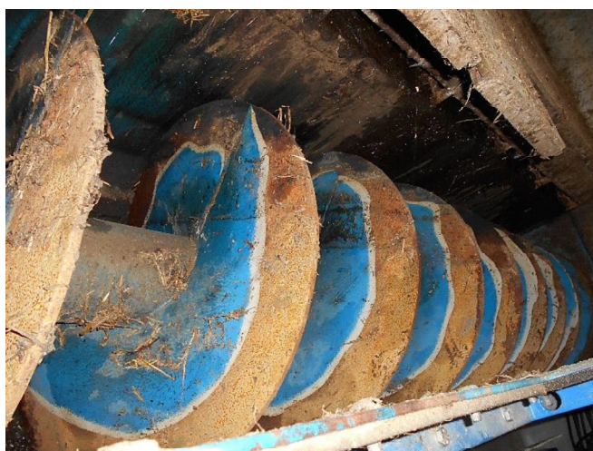
Fig. 16. Vis sans fin permettant l'alimentation de la cuve d'hydrolyse, prise à La Ferté Saint-Aubin (Photo personnelle, 31 mars 2016)
