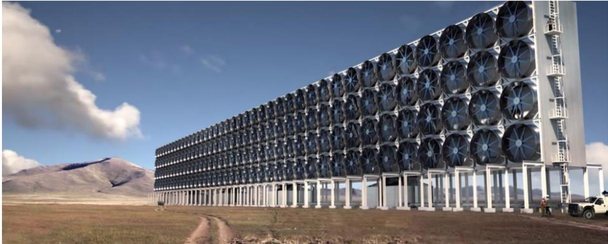
Figure 31 - Modules de capture par Carbon Engineering
