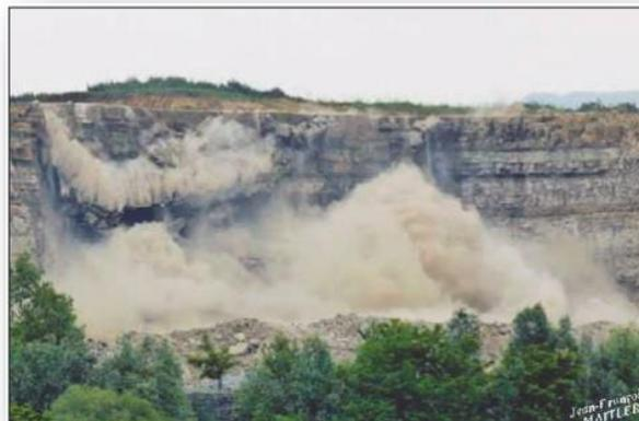
Figure 14: empoussièremement de l'air dû aux tirs de mines<sup>13</sup>
