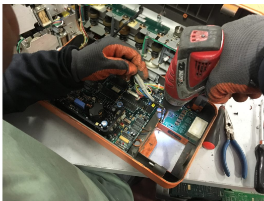
FIGURE 1 – Démantèlement manuel d'un oblitérateur (CF2D - Economie sociale et développement durable, 2016)
