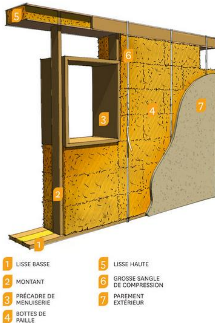
Figure 10 : Schéma de construction avec la technique des ballots porteurs
