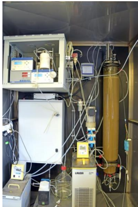
Figure 23 : Réacteur de méthanation biologique à lit fluidisé du projet HYCABIOME . Source : Solagro (2019).
