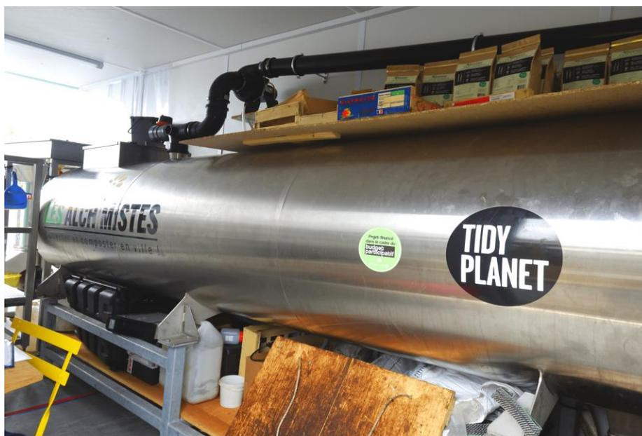
Photo 4 – Composteur électromécanique
