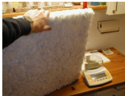
Picture 4: tapis d'isolation en fibres de verre recyclée (31)
